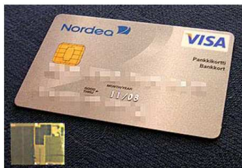
Slika 8 – Izgled kontaktne mikroprocesorske pametne kartice
