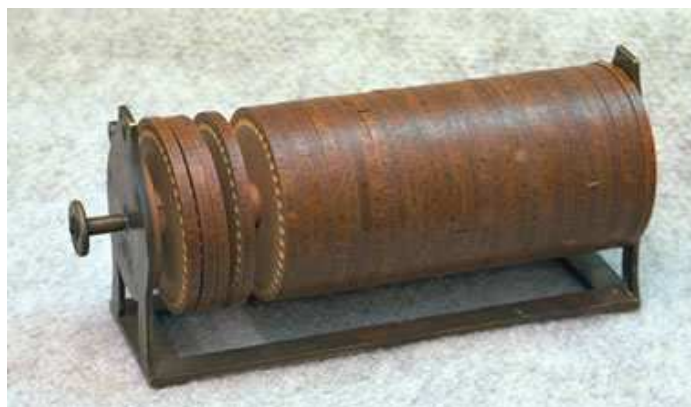
Slika 2. Thomas Jefferson-ov instrument za kodiranje sa točkovima
